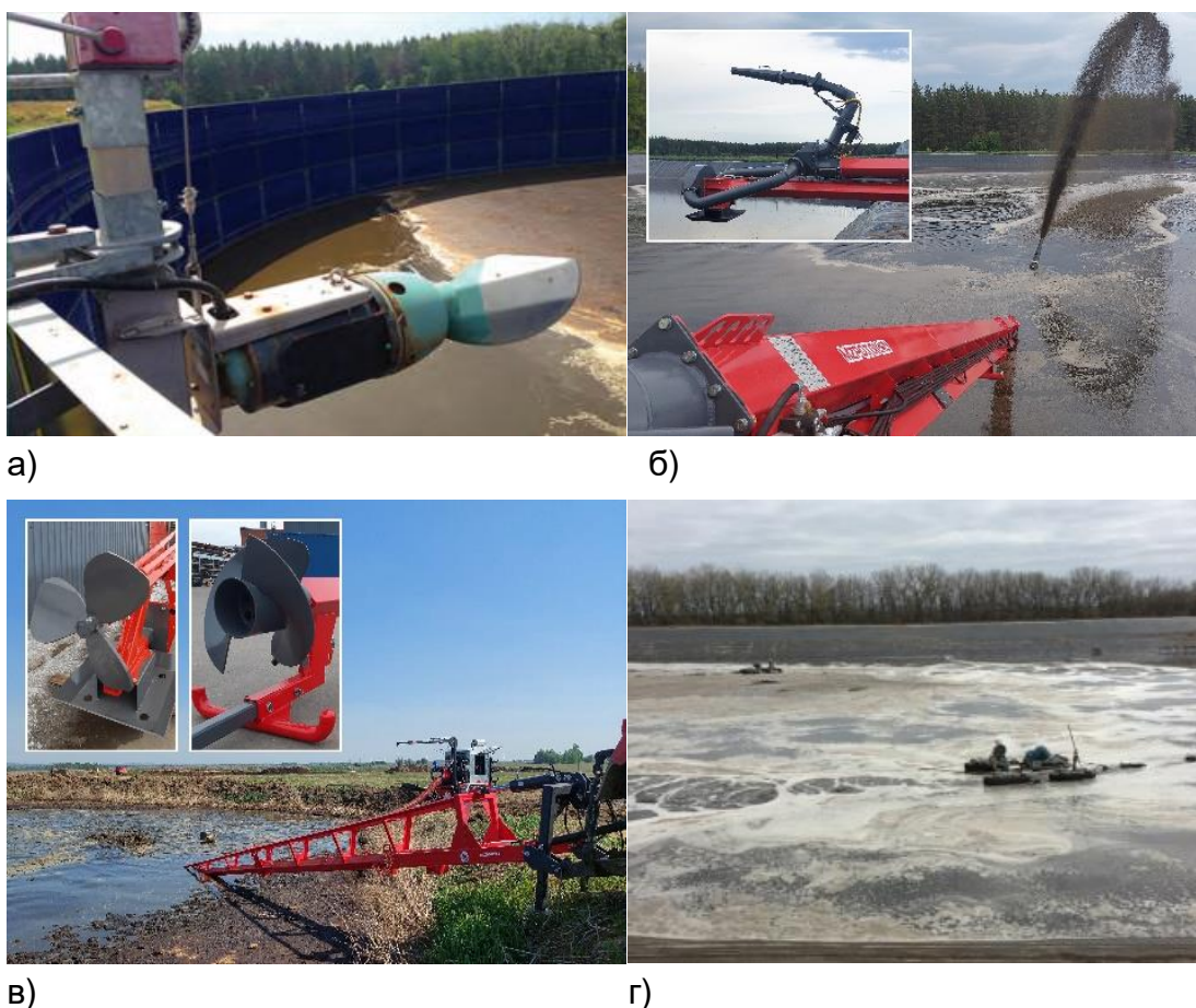
Рисунок 2.60 – Перемешивающее оборудование для навозохранилищ: а – стационарный миксер на цилиндрическом навозохранилище; б – передвижная (лагунная) помпа; в – передвижной (лагунный) миксер; г – миксер-аэратор
