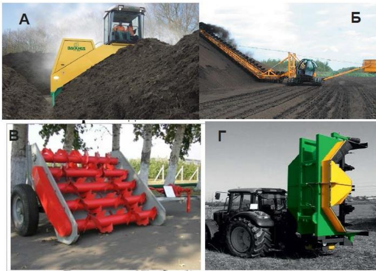
Рисунок 2.66 – Примеры машин для аэрации буртов: А – погрузчик-бульдозер, Б – смесители-буртователи, В – прицепные и самоходные ворошители компоста, Г – валкователи-смесители
