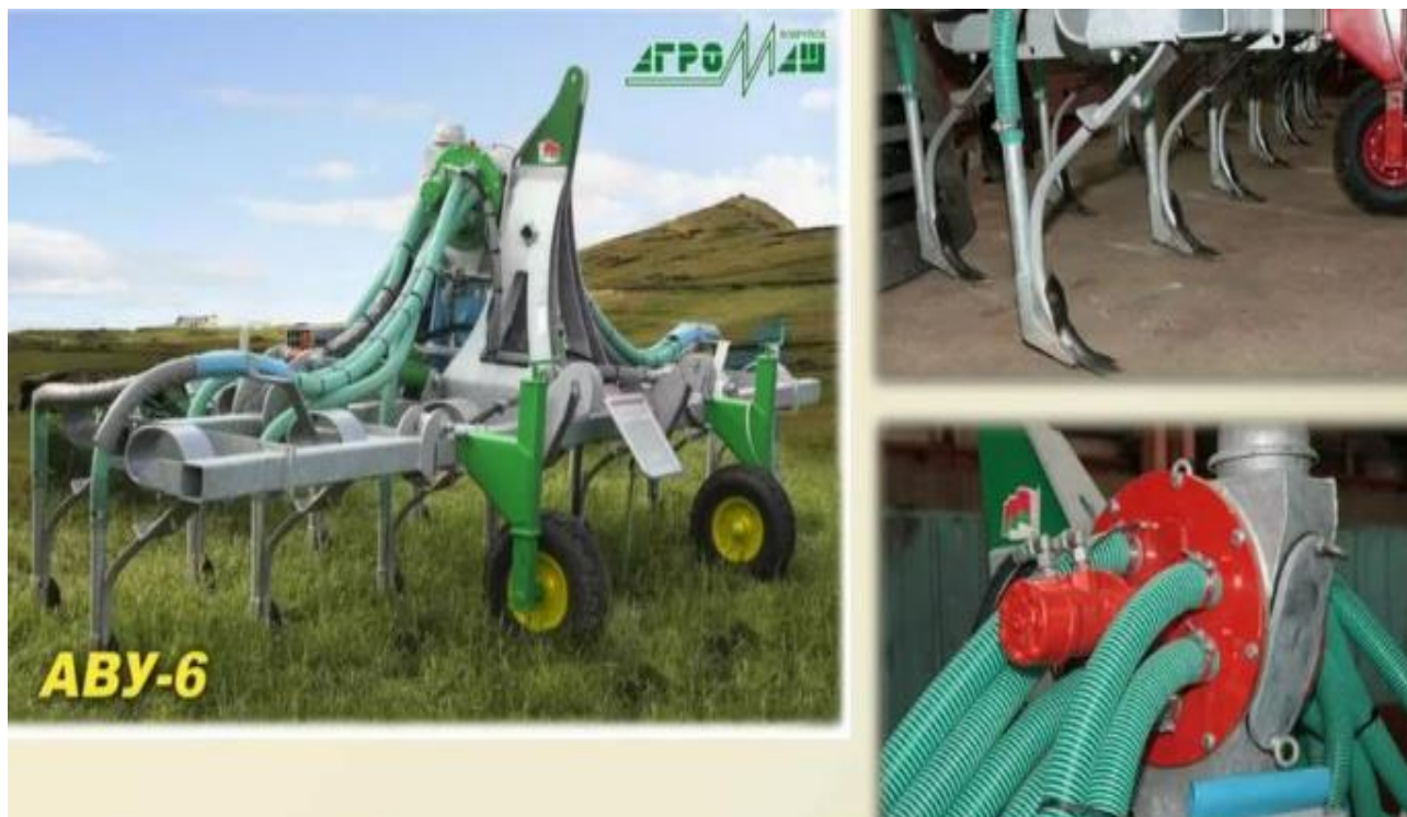
Рисунок 2.73 – Внутрипочвенное внесение под давлением жидкого органического удобрения в открытые бороздки
