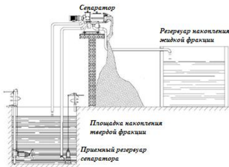
Рисунок 2.63 – Схема разделения свиного навоза на фракции
