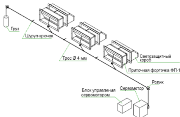
Рисунок 2.29 – Устройства для механического открытия приточных клапанов
